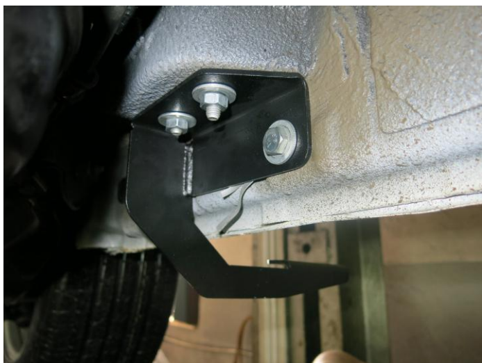
Рис. 4 - Установка заднего кронштейна
