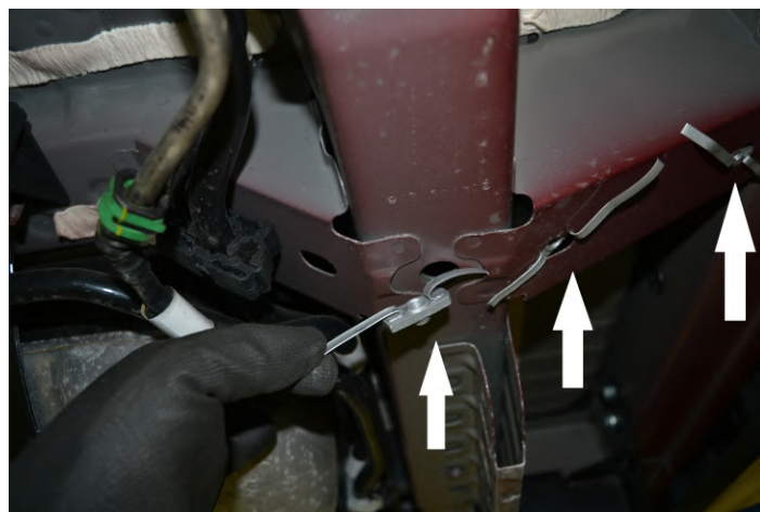
Рис. 2 - Установка закладных гаек в средней части автомобиля
