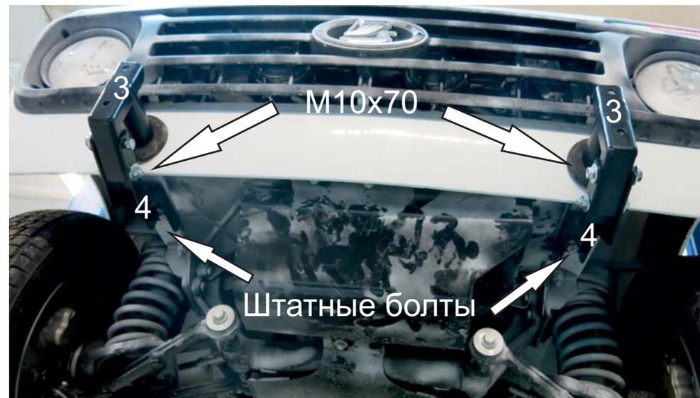
4. Смазать кронштейны (поз.3) солидолом или литолом (так же подойдет моторное масло или любая техническая смазка) и установить их в отверстия от штатного бампера.
