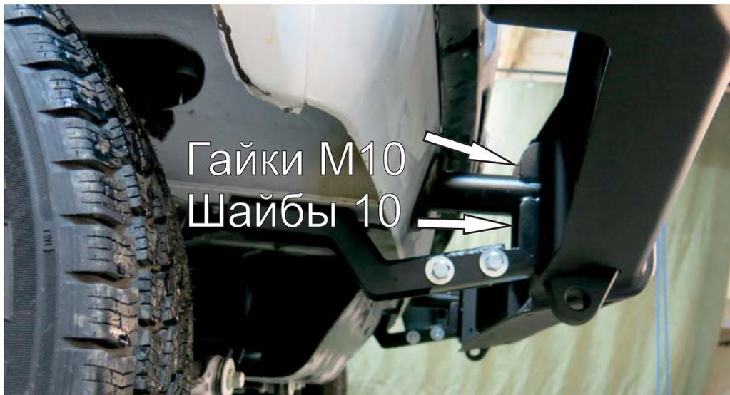
7. Установить закладную планку (поз. 4) внутрь бампера. Рекомендуется зафиксировать с помощью двустороннего скотча.
