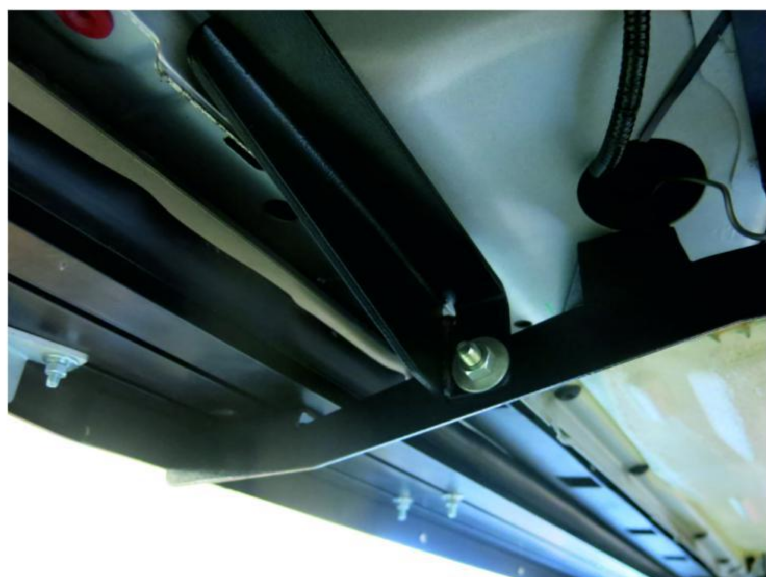
Рис. 3 - Стягивание задних кронштейнов
