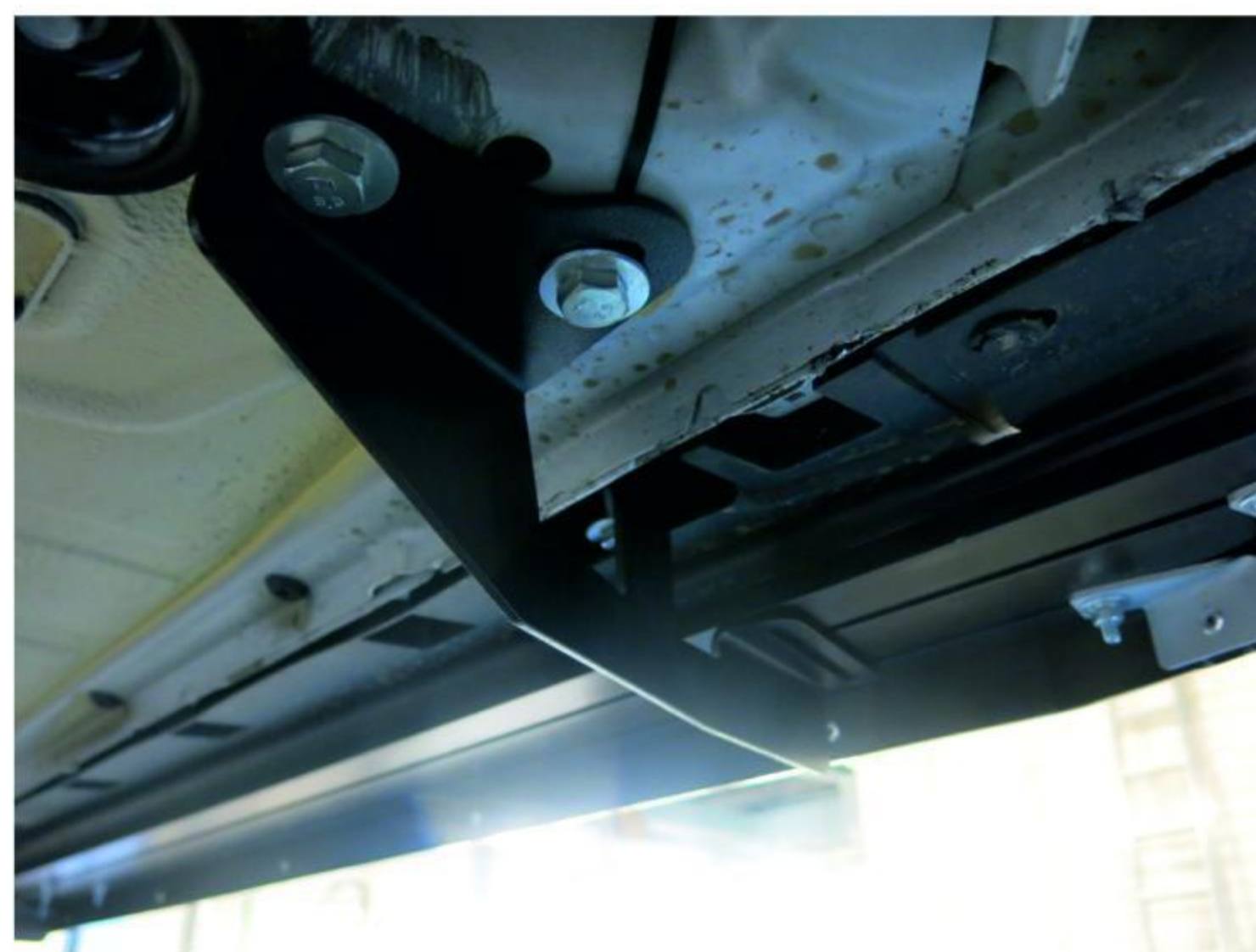
Рис. 4 - Установка переднего кронштейна
