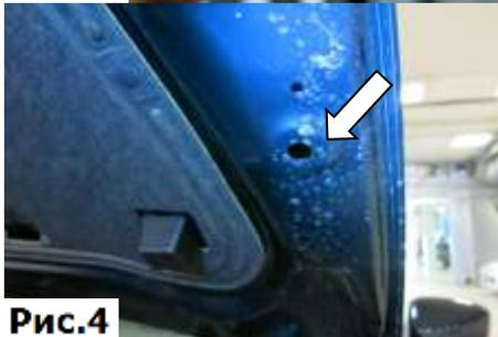
4. Болт-шарнир будет устанавливаться в указанное технологическое отверстие в усилителе капота, (Рис.4).
