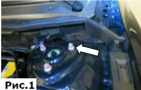
1. Торцевой головкой №14 открутить гайку крепления опоры передней подвески, (Рис.1).
