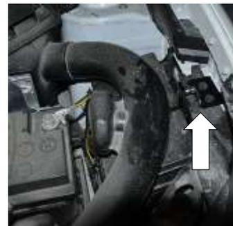
2. Установить кронштейн крыла, как показано на рисунке. Плотнo прижать подгиб кронштейна к кузову и затянуть болты ключом №13 с усилием 23 Нм.
